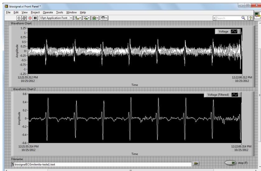
**Figura 2.** Sinais de ECG contaminado com ruído e medidos de uma paciente anônima voluntária com ganho total de 2000x com acoplamento-DC (superior). Sinal de ECG com filtragem usando *wavelet*, (inferior).
