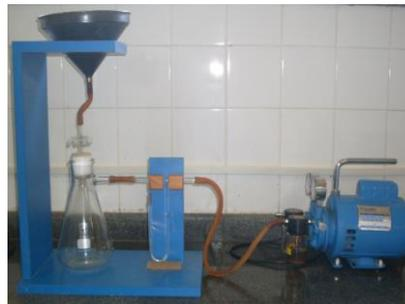
Figura 5. Equipamento utilizado na determinação da retenção de água
