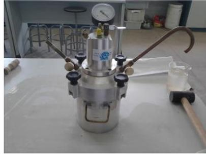
Figura 3. Medidor de ar incorporado (pressiômetro)
