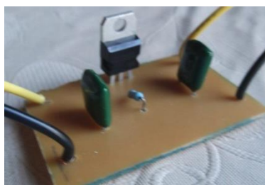
Figura 3 - PCI do regulador de tensão. (Fonte: Elaborada pelo autor).
