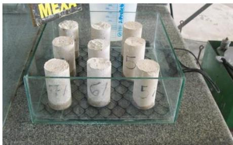
Figura 3. Ensaio de absorção por capilaridade
