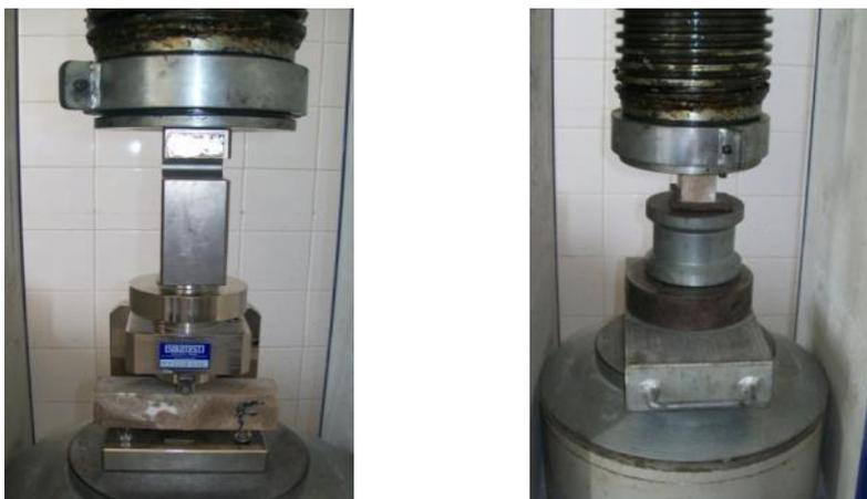
Figura 2. Ensaio de resistência à tração na flexão (a) e resistência à compressão (b)
