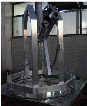
Figura 5: Rastreador solar e sensor pireliômetro fabricado pela Keep & Zonen.
