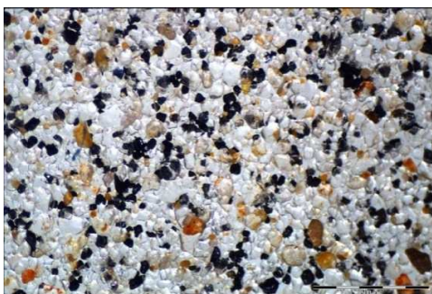
Figura 3 – Grãos de quartzo hialino (incolor), ilmenita (cor preta), calcedônia ou cornalina (sílicas alaranjadas) da amostra composta enviada à CPRM.
