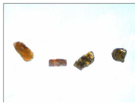
Figura 6 – Minerais, da esquerda para a direita, titanita, dois do meio estauroлита, da direita mineral verde espinélio da amostra composta enviada à CPRM.
