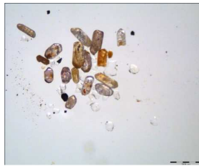
Figura 4 - Grãos de zircões (incolores são quartzos) da amostra composta enviada à CPRM.
