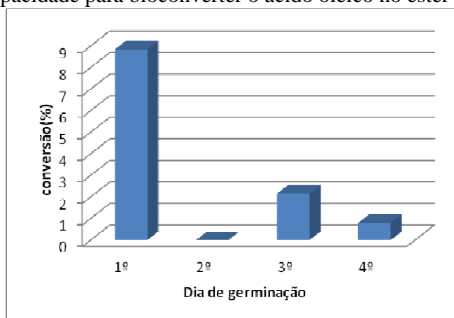
Gráfico1: Conversão de ácido oléico utilizando como catalisadores sementes do 1º ao 4º dia de germinação. Tempo de 15 minutos. 60°C. Solvente hexano (5mL). Proporção ácido oléico: glicerol (1:1).
