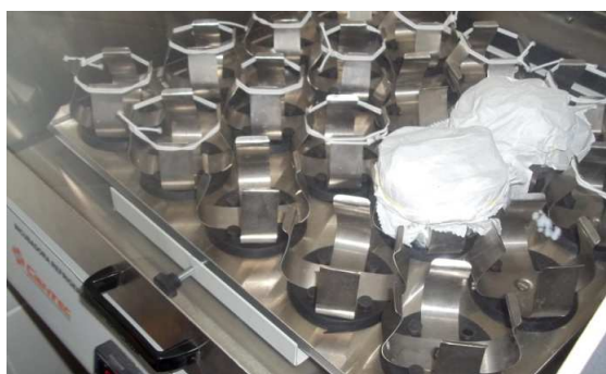
Figura2. 12 frascos de reações sendo conduzidos sob aquecimento à temperatura de 60°C e agitados.
