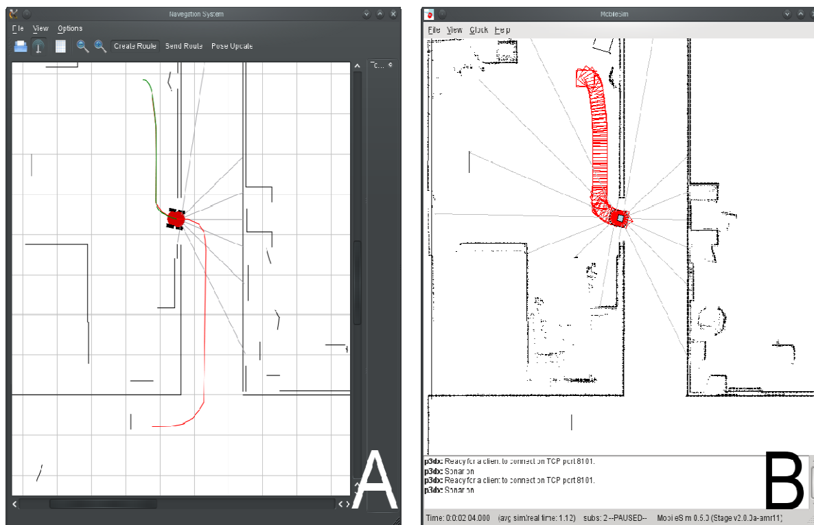
Figura 1: Navegação do robô. A - Trecho de rota executada pelo robô. B - Simulação do robô real pela ferramenta MobileSim .
