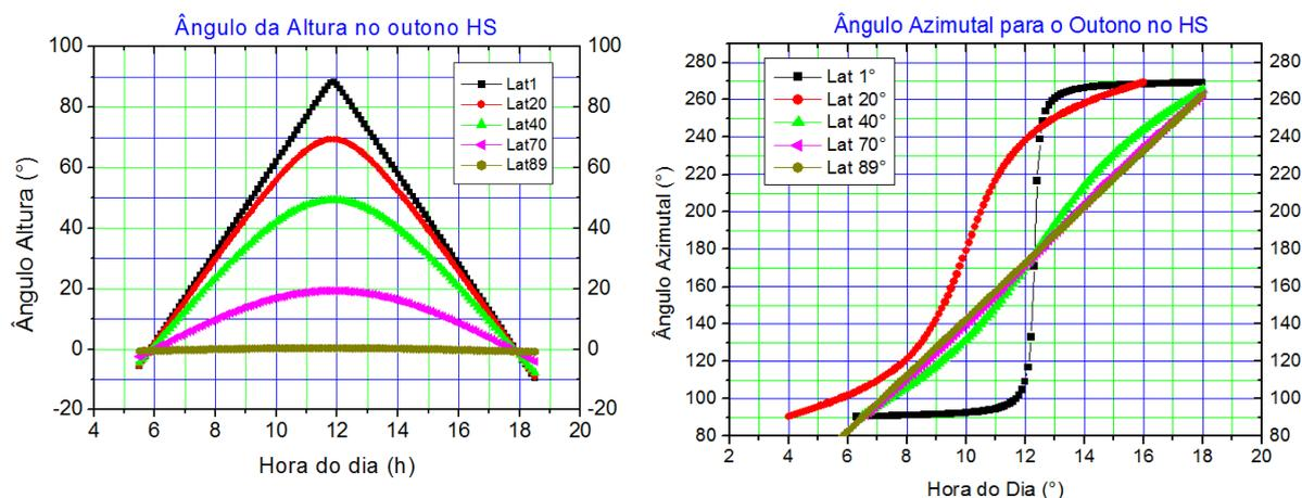
Figura 4: Ângulos Altura e Azimute calculados pelo algoritmo PSA adaptado para diversas latitudes do Hemisfério Sul no Equinócio de outono.
