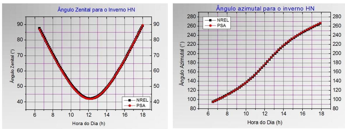
Figura 2: Comparação dos dados obtidos pelo NREL e calculados pelo nosso algoritmo PSA adaptado para o dia 14 de março de 2011
