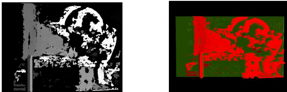
Figura 3 – Exemplo da geração da malha poligonal para a imagem do mapa de disparidade obtida do módulo de visão estéreo
