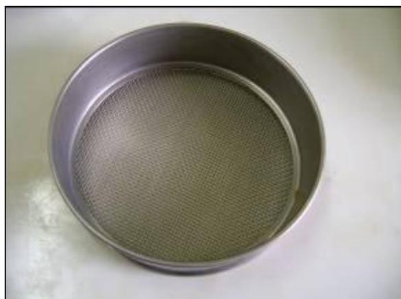
Figura 3: Peneira (malha de 2mm)
