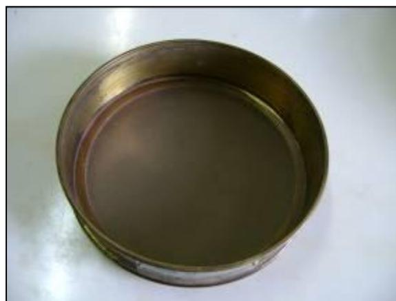
Figura 4: Peneira (malha de 0,177mm)
